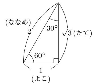
$30^\circ$ 、 $60^\circ$ 、 $90^\circ$  タイプの直角三角形
