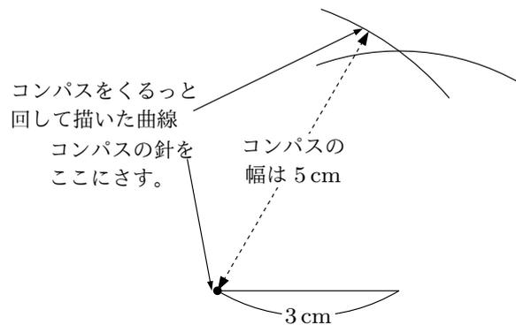
右の図を見てください。最後に、「コンパスの幅を 4 cm に開いて描いた曲線」と「コンパスの幅を 5 cm に開いて描いた曲線」の交点をそれぞれ「3 cm の長さの線分」の両端と定規でまっすぐ結びます。これで完成です。
