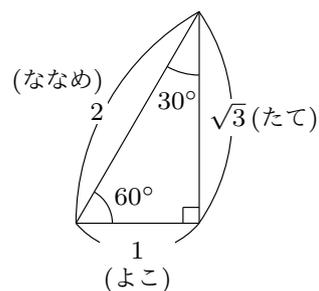
$30^\circ$ 、 $60^\circ$ 、 $90^\circ$  タイプの直角三角形
