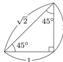
$45^\circ$ 、 $45^\circ$ 、 $90^\circ$  タイプの直角三角形
